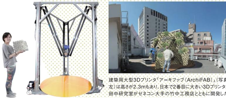
建築用大型3Dプリンタ「アーキファブ（ArchiFAB）」（写真左）は高さが2.3mもあり、日本で2番目に大きい3Dプリンタ。田中研究室がゼネコン大手の竹中工務店とともに開発したもので、高さ約50cm、直径約1.3mの円柱に収まるサイズのものを出力できる。プリンタ自体を分解することができるため、運搬して現地で組み立てることが容易であることも特徴だ。
